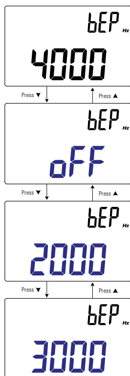
Figura 3-13 Modifica della frequenza del segnale acustico
